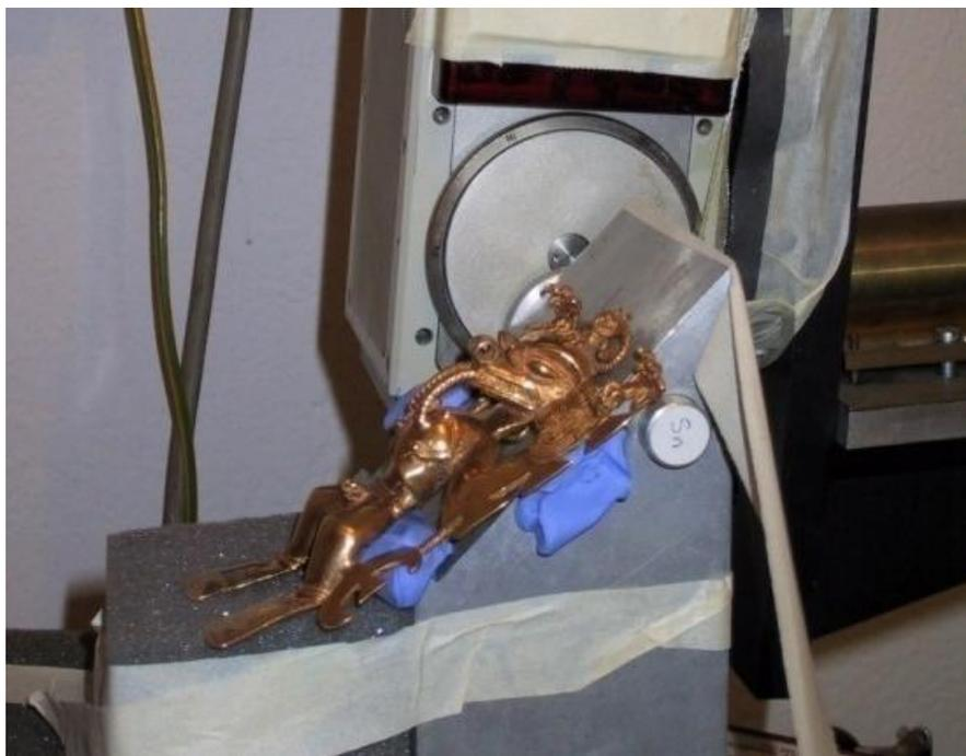
*Figura 3.4.* Análisis por XRF. BCCR 1250.
