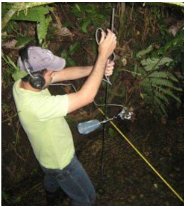
Foto 4. Procedimiento de aforo con molinete en la quebrada Chanchera. En el sitio de aforo No. 2, en el puente del sendero que se encuentra a 40m —en línea recta— de la caseta de información, a la entrada del Monumento Nacional Guayabo de Turrialba. (Op. 33b).
