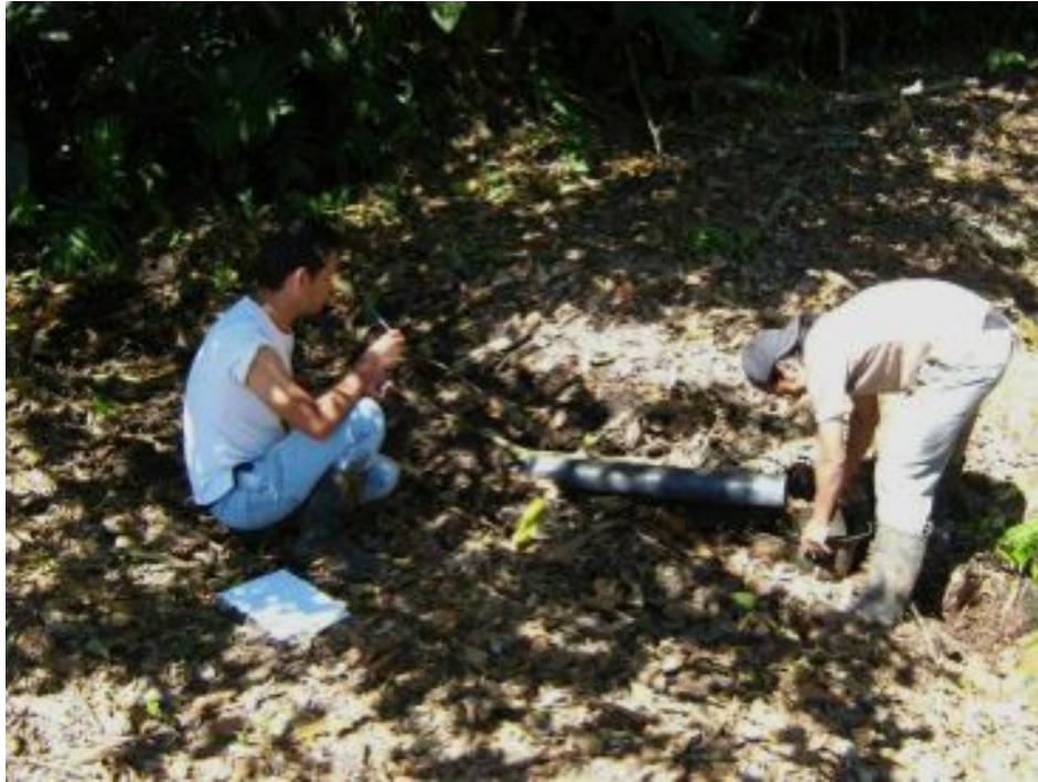
Foto 7. Registro de caudal con el método volumétrico en el sitio de aforo No.8, en el pie de monte, a 21m al noroeste del estanque de captación (estructura 14b). (Op. 33b).
